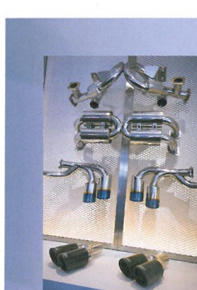
←オリジナルのエキゾーストもエナジーのもの。ステンレス製でJASMAの認証も取得している。カッターも複数用意されているので、好みに合わせて選びたい
