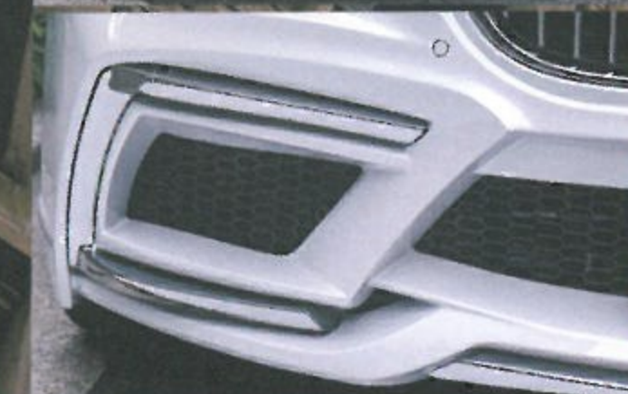
→フェイスを一気に個性化するフロントバンパー。サイドのこの字型の別体パーツはステンレス製。オプションでデイトライト+スモークカバーも選べる
