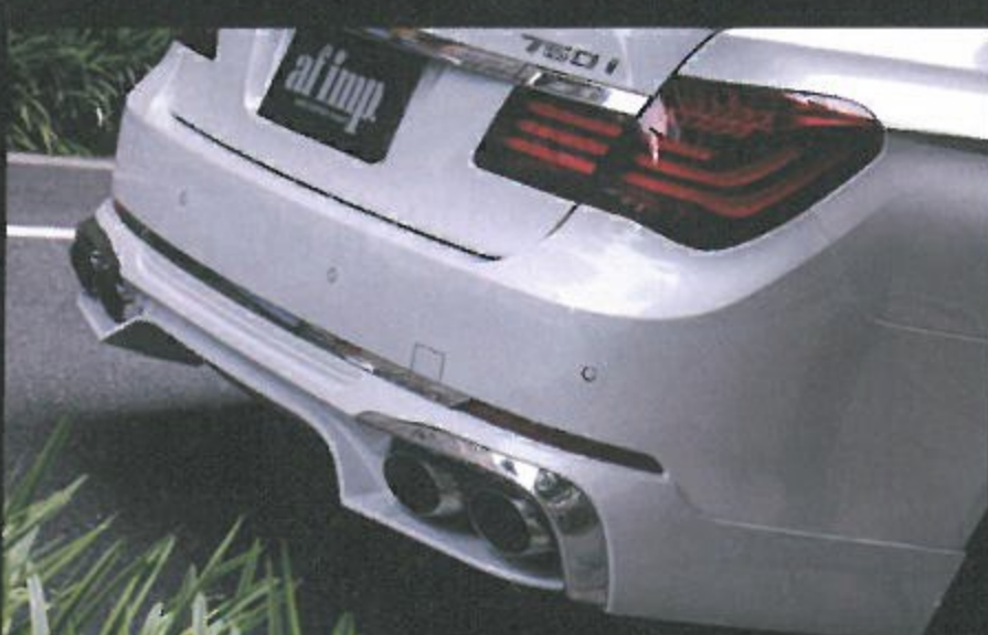
→ハーフ形状のリアアンダースポイラー。フロント同様、マフラー周囲にステンレスパーツを採用し、純正メッキ部分との連携感を出している
