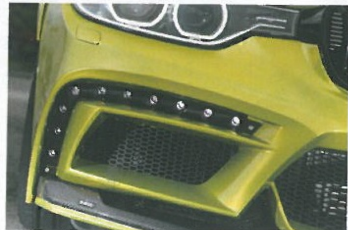
↑開口部には10連、もしくは4連LEDデイランプを装着することも可能。標準でカバーが付属しており、非点灯時はLEDの存在を隠す
