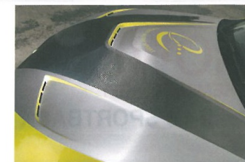
←ボンネットはノーマルよりも高さを出し、そこにダクトやプレスラインを投入した完全オリジナル。カーボンエディションも設定
