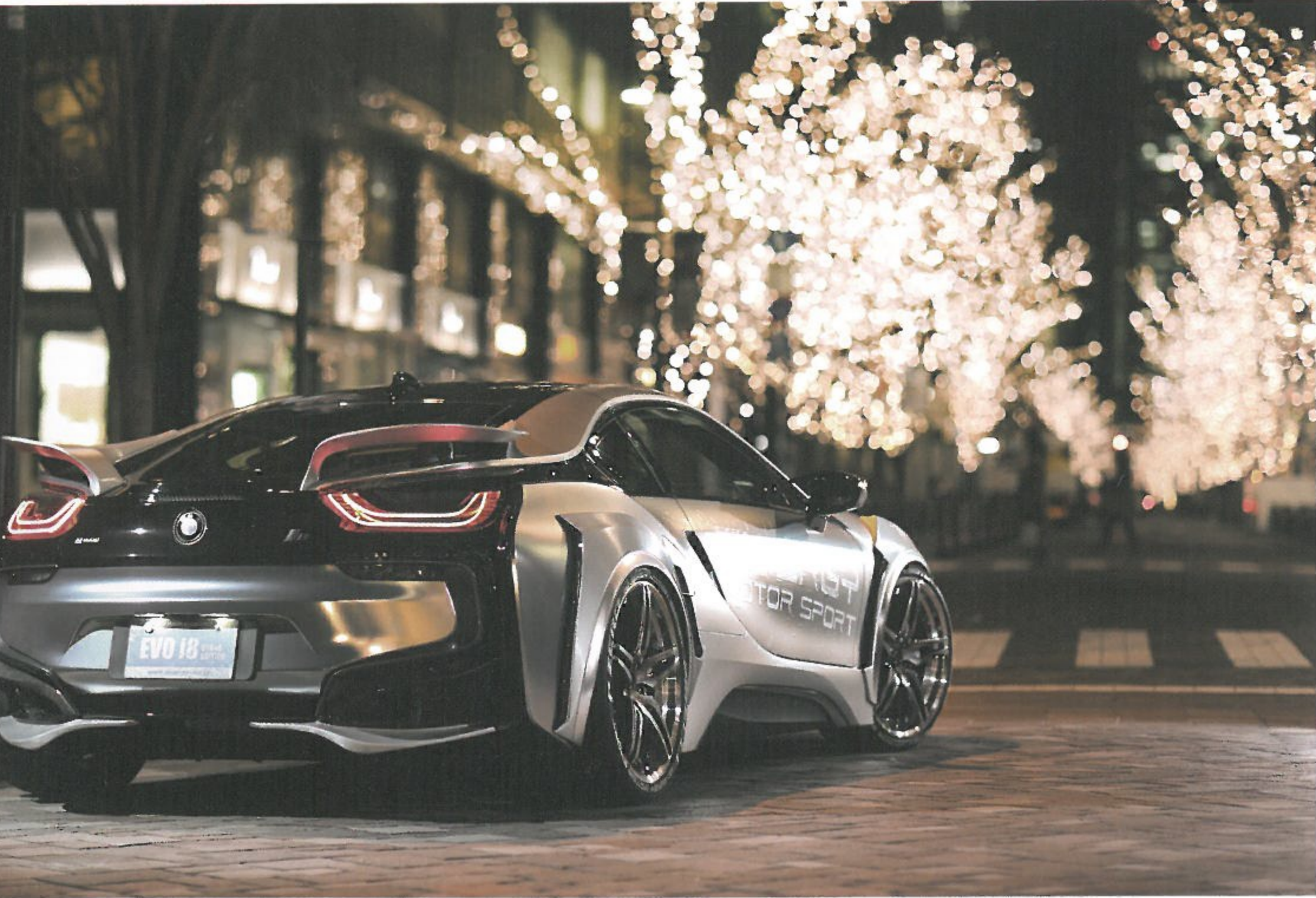
前後のページに出てくるi8と比べてもらうとわかりやすいが、オーバフェンダーの設置により、サイドにダクトが設けられる構造になっている。
