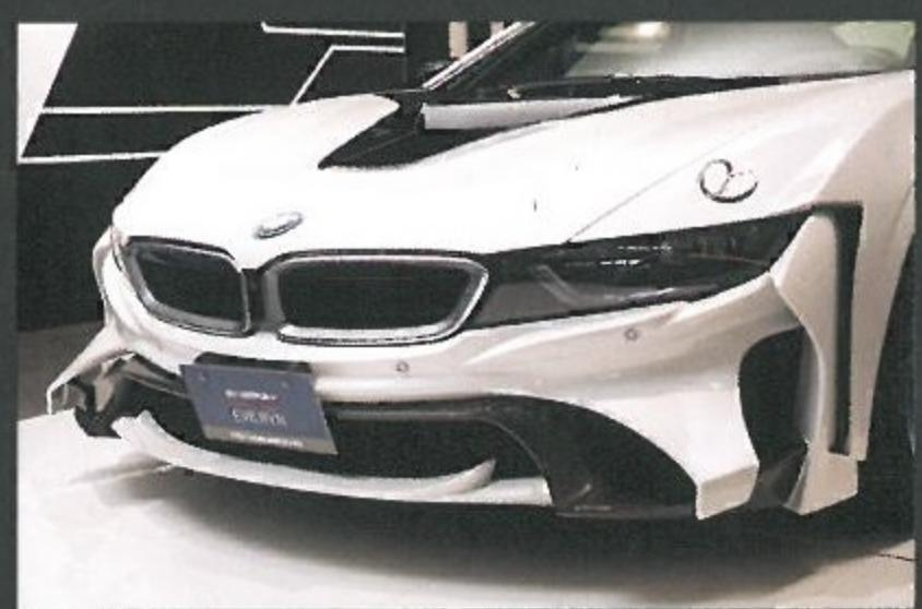
フロントバンパーは、ボディ底面への空気の導入とサイド方向への流れを考慮したものだが、カーボンとの混合デザインでフォーミュラカーのウイングを見せてくれる。
